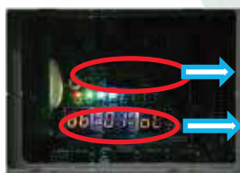
Botón de depuración Debugging button Tres tubos nixie dual-8 muestran el estado de depuración con alta legibilidad Three dual-8 nixie tubes display debugging status with high readability
